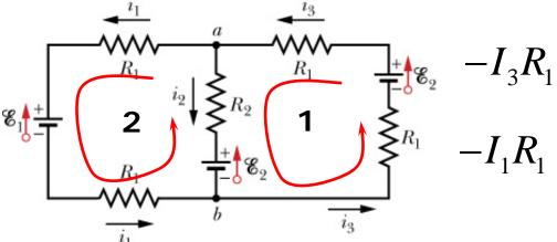
$$-I_{3}R_{1} - I_{2}R_{2} - E_{2} - I_{3}R_{1} + E_{2} = 0$$
